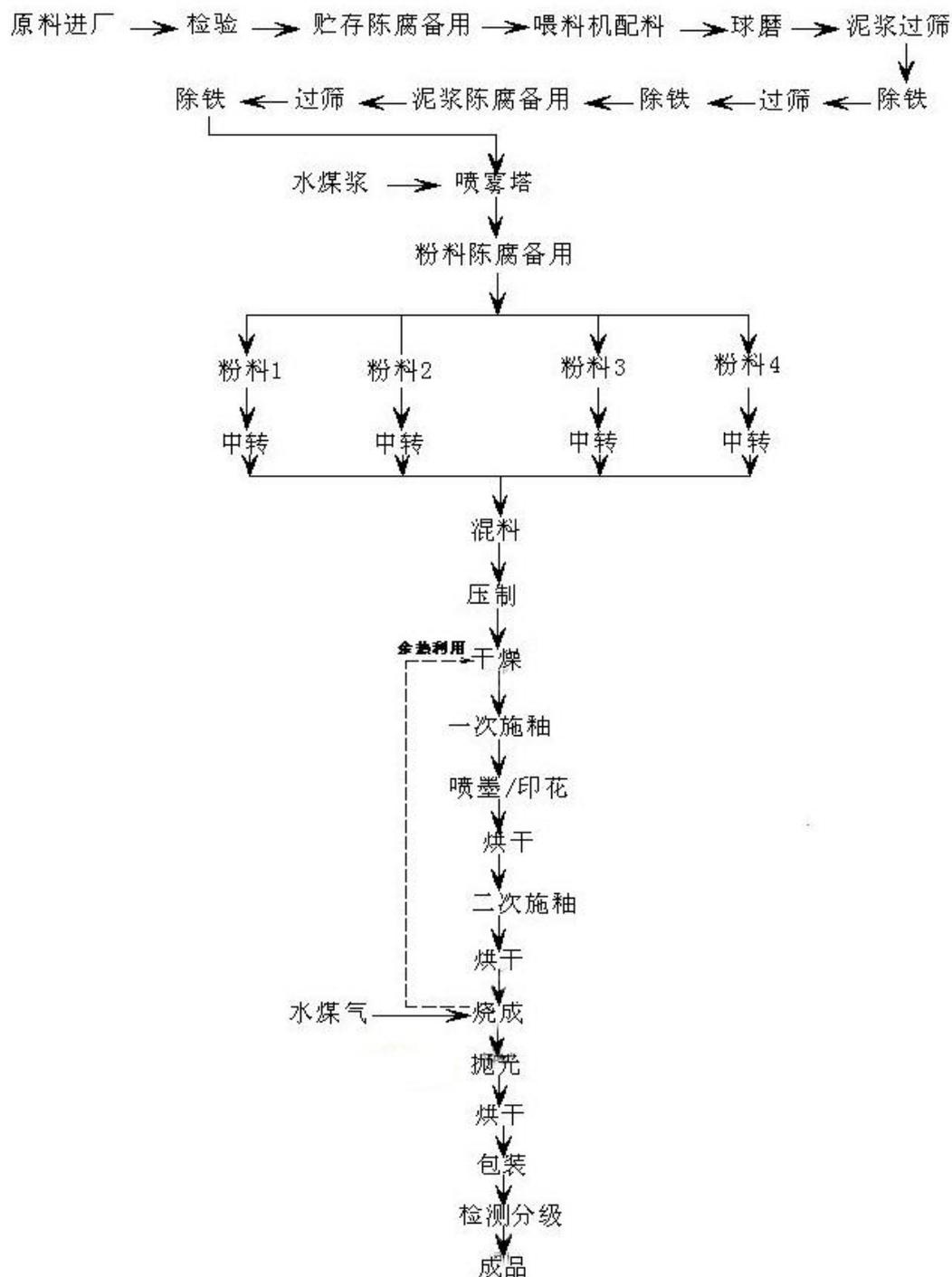
图2-3 陶瓷生产工艺流程图
