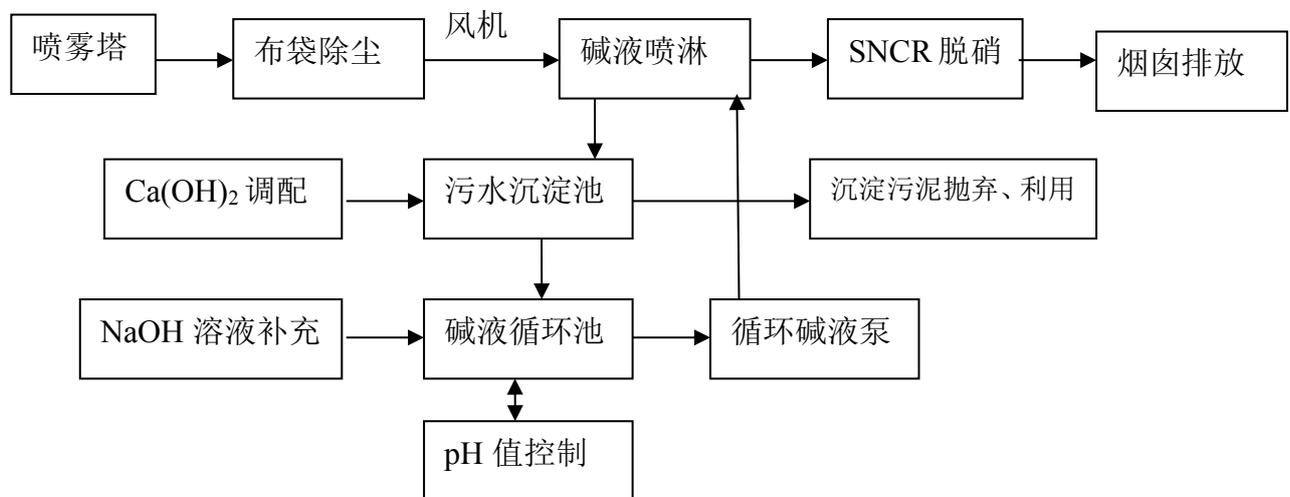
图2-5 喷雾塔废气处理工艺流程图
