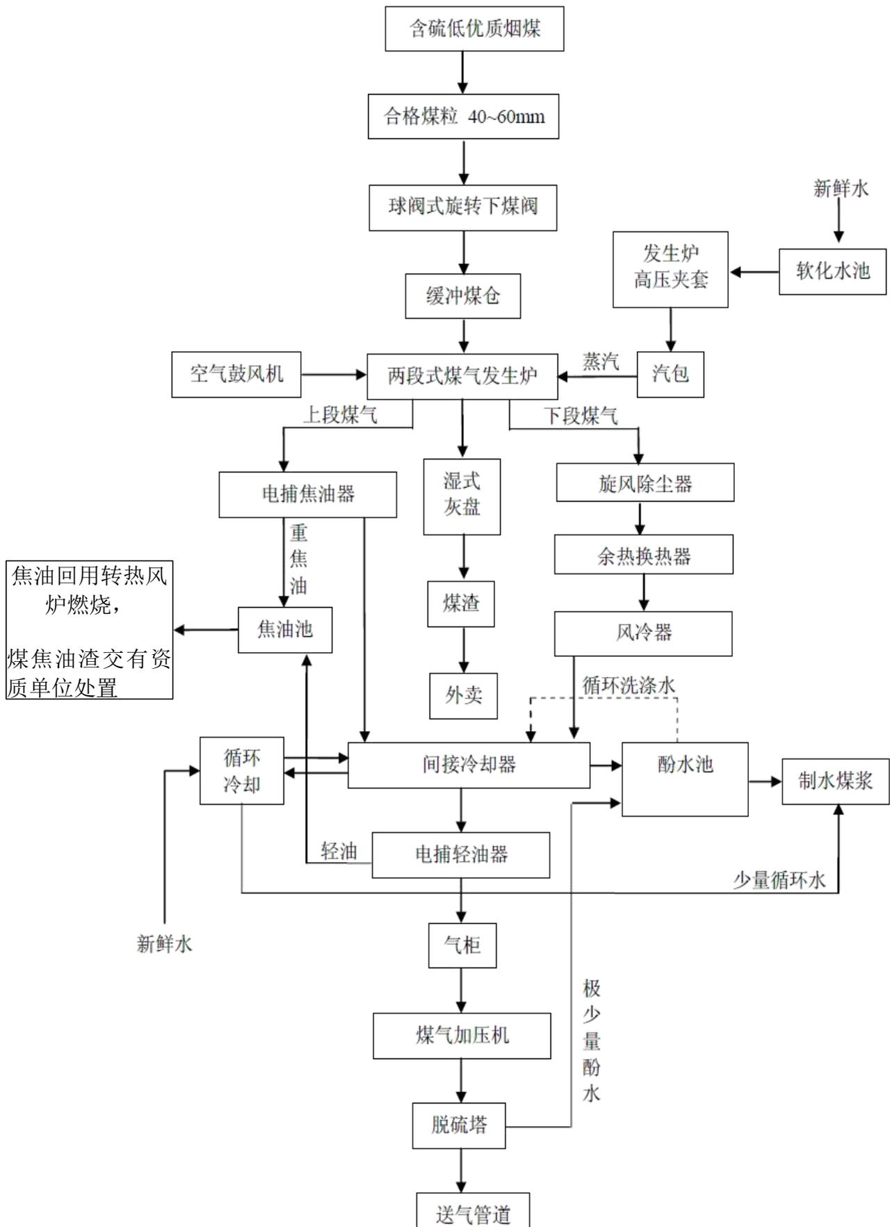
图2-4 水煤气生产工艺流程
