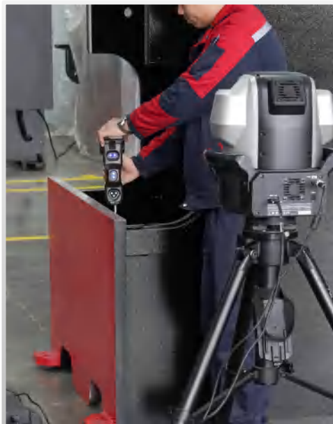
工作人员正在使用三坐标测量仪检测 每一台设备
