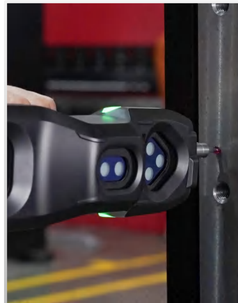
测量折弯两立面精度（确保机架精度 的一致性）
