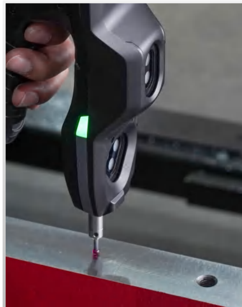
测量折弯机整个工作台面精度（确保 加工成型的绝对精度）
