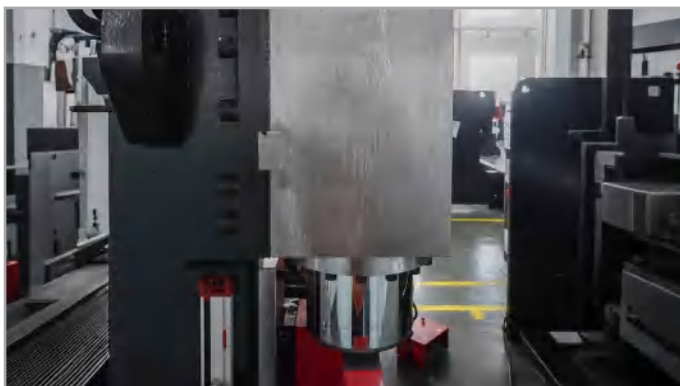
装配在机器上的油缸实物图
